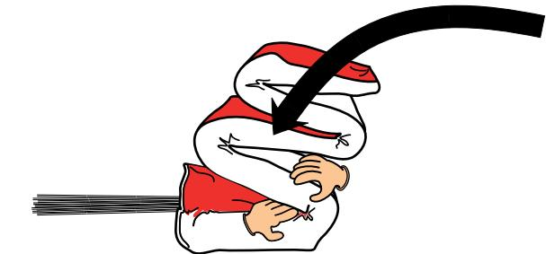
12. Stülpe den Innencanister über den «S» gefalteten Rettungsschirm und drehe das gesamte Paket kopfüber. Lasse ein wenig Platz an der Vorderseite der Rettungsschirm-Vorderkante, um später die Leinen falten und verstauen zu können..
