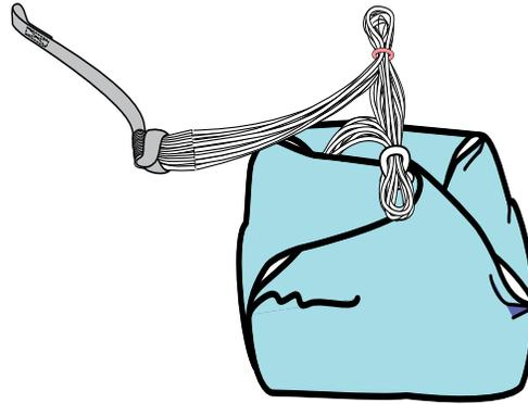
15. Fermer le quatrième rabat et glisser une boucle de lovage du suspentage (environ 4 cm) dans l'élastique principal pour assurer la fermeture du pod.
