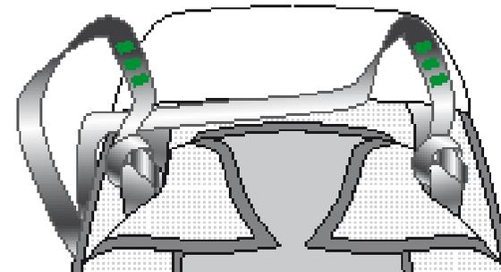
>> Verbindung Rettungsgerät – V-Rettungsverbindungsleine (2 einzelne)
