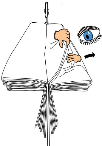
9. Lover la partie gauche du sapin en « S » sous la partie centrale puis lover la partie droite du sapin en « S » sur la partie centrale. Maintenir le lovage de la voilure avec des sacs de sable.
