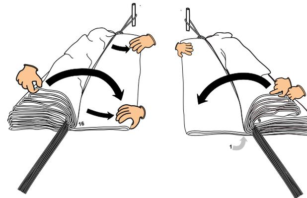
**6.** Contrôler à gauche et à droite, en haut et en bas que le nombre de panneaux sortis soit identique et correct. En profiter pour parfaire l'alignement des bords d'attaque.
