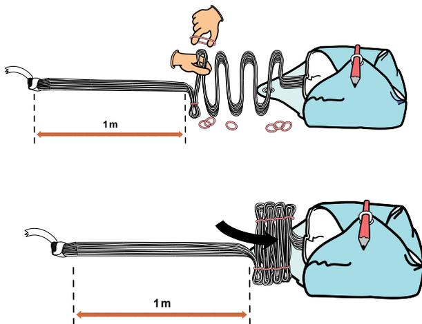
15. Schließe das letzte Blatt und mache den Innencontainer zu, indem eine 4 cm lange Leinenschleife in die Hauptgummischleife eingeschoben wird.
