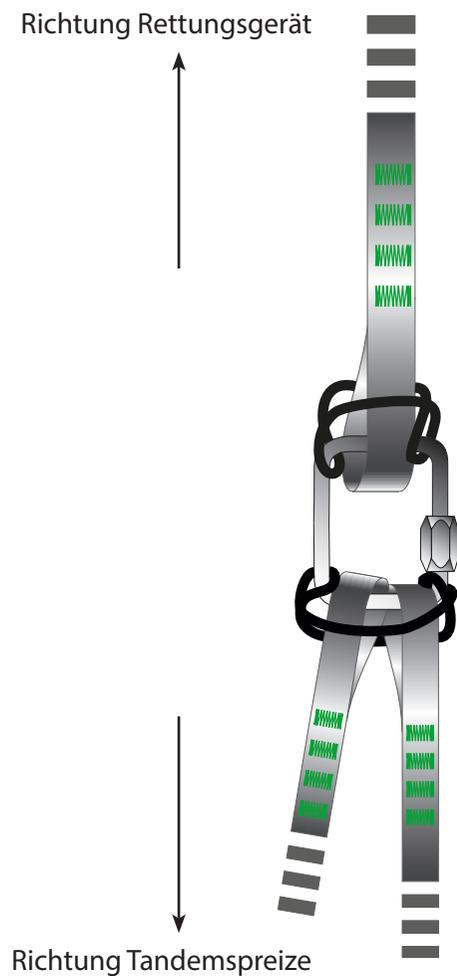
2. Verbinde jeweils die Verbindungsleinen (Verlauf über die Schulter) mit rechteckigen 6 mm Edelstahrschraubschäkeln (Inox) + Gummiringfixierung mit der jeweiligen Spreizenhauptaufhängung.
