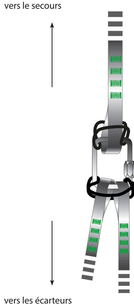
2. Fixer un éleveur de parachute sur chaque écarteur : sur les points d'accroche principaux, avec un maillon carré de 6 mm (minimum) + joint torique.
