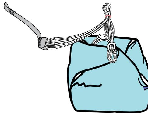
17. Wenn der Notschirm schön gepackt ist, kontrolliere durch das gleiche Inventar wie bei Stufe 1, dass kein Hilfsmittel fehlt und irgend etwas im Schirm vergessen wurde!
