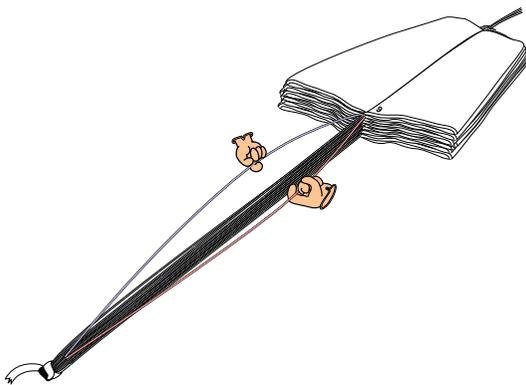
9. Falte die linken Bahnen der Länge nach auf eine S-förmige Weise unter die Mitte der Schirmkappe. Falte nun die rechten Bahnen der Länge nach auf eine S-förmige Weise über die Mitte der Schirmkappe. Halte die Schirmkappe mit Sandsäckchen oder Bücher schön gefaltet.
