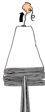
8. Contrôler que les deux suspentes inférieures et que les deux suspentes supérieures courent librement de la voilure aux éleveurs.
