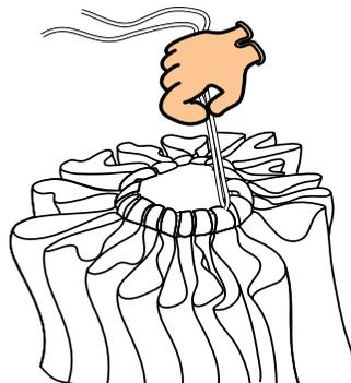
**4.** Utiliser la drisse placée pour mettre le parachute en tension. Dégager les deux suspentes extérieures sur l'élèveur.
