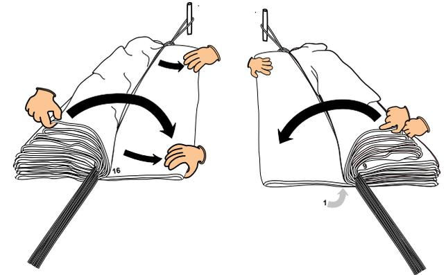
6. Kontrolliere nun, dass eine identische Anzahl Bahnen (gemäß der gesamten Anzahl der Bahnen übereinstimmend mit den technischen Daten deines Notschirmes) rechts und links vorliegt und die Basiskanten sauber aufeinander ausgerichtet sind.
