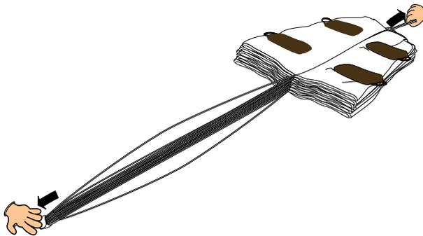
**5.** Arranger en sapin la moitié des panneaux côté droit (panneaux rouges), de bas en haut. Répéter avec les panneaux de gauche (panneaux blancs).
