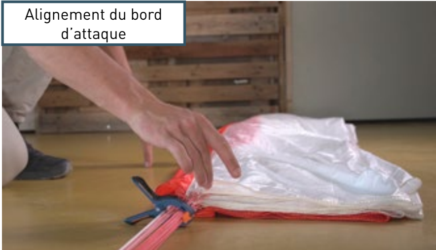
Mise à plat du premier panneau
