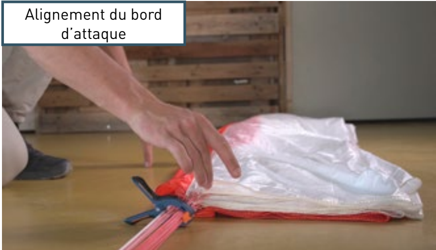
Mise à plat du premier panneau
