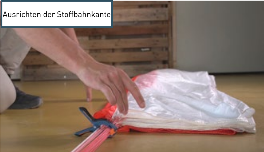
Glätten und ausrichten an der Faltenmarkierung.
