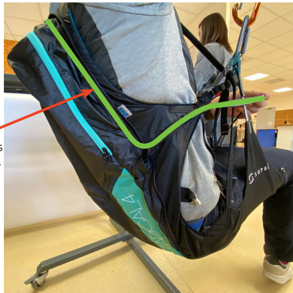
Cheminements des élévateurs
