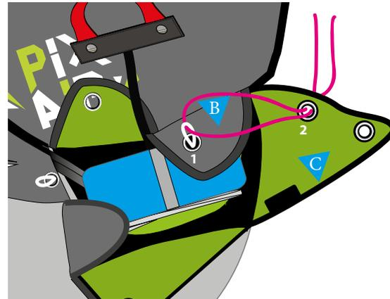
3. - Zur Befestigung führe die rechte Seite des gelben Kabels durch den elastischen Loop #1
