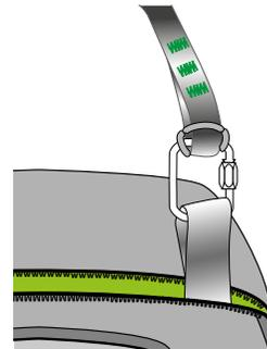
5. - Fahre mit einem fehlerfreien und präzisen Einbau fort- Versichere dich, dass die Schlaufen der Verbindungsleinen nicht verrutschen können.
