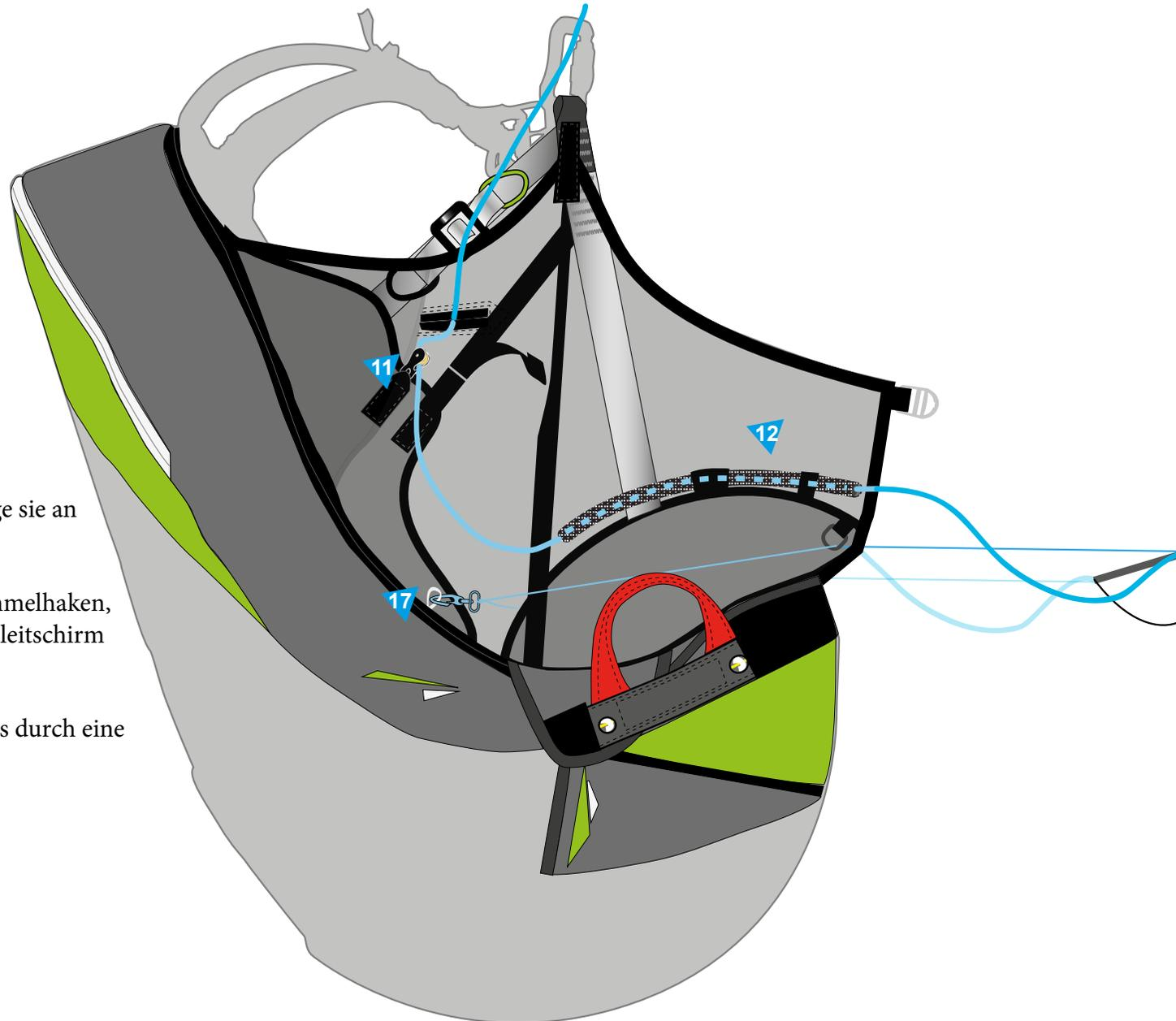
1. Fädle den Beinstreckergurt durch den Versteller, der an der Seitenverkleidung vorne seitlich angebracht ist.
