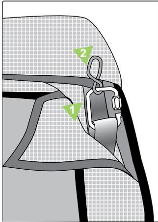
2. Fädle die Rettungsverbindungsleine durch den O-Ring und hänge sie in den Schraubschäkel
