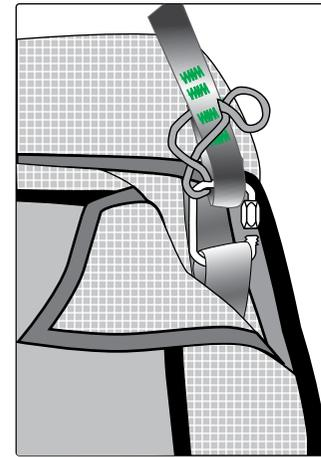
4. Wiederhole Schritt #1, #2, und #3 mit einem weiteren O-Ring für die Verbindung zum Gurtzeug. Schließe den Schraubschäkel korrekt, falls nötig mit einer Zange.
