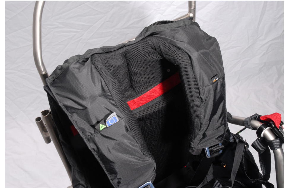
A la fin du montage : refermer les volets cache élévateurs pour obtenir une sellette bien finie.
