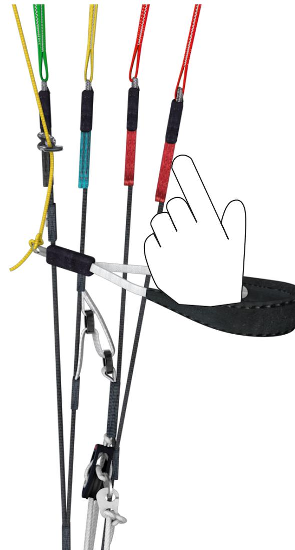
Pour rouvrir les oreilles, relâchez l'accélérateur, puis les élévateurs symétriquement. Conformément à la norme les oreilles se rouvriront seules, mais vous pouvez effectuer un freinage ample d'un côté puis de l'autre pour faciliter la réouverture.
