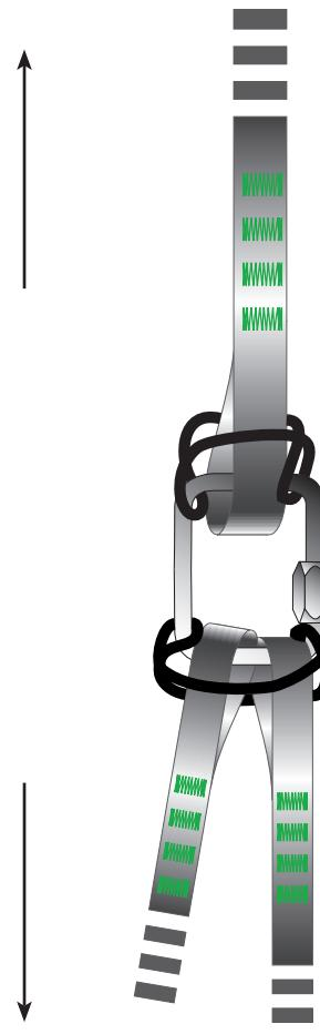
2. Fija una banda del paracaídas de emergencia sobre cada separador: en los puntos de anclaje principales y con un maillon cuadrado de 6 mm (como mínimo) + una junta tórica.
